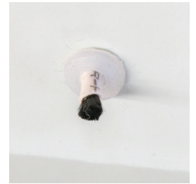
Metallborsten im Lampengehäuse zur Ionisierung.
