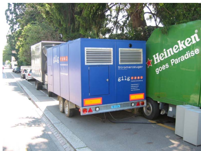
Bild: Schallschutzverkleidung für mobilen Stromerzeuger
